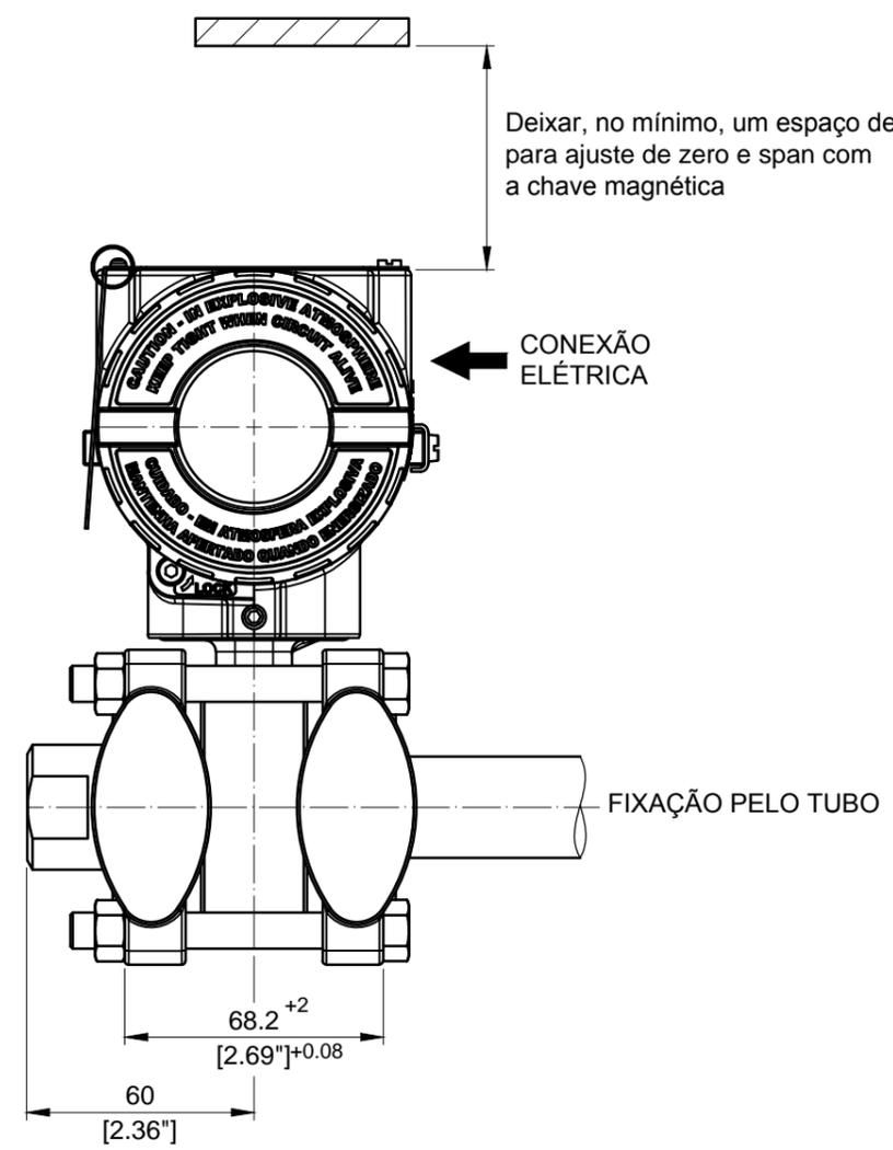
Deixar, no mínimo, um espaço de 150mm para ajuste de zero e span com a chave magnética
