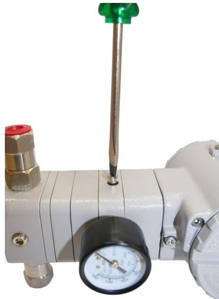
Figura 4.3 – Removendo a restrição do conversor
