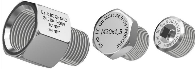
Os bujões consistem em dispositivos maciço de vedação, fabricados em aço inox (ASTM – A240 Liga 316) providos de rosca NPT e Métrica. As buchas de redução consistem em dispositivos de adaptação, fabricadas em aço inox (ASTM – A240 Liga 316), providas de rosca de 3/4" NPT e 1/2" NPT.
