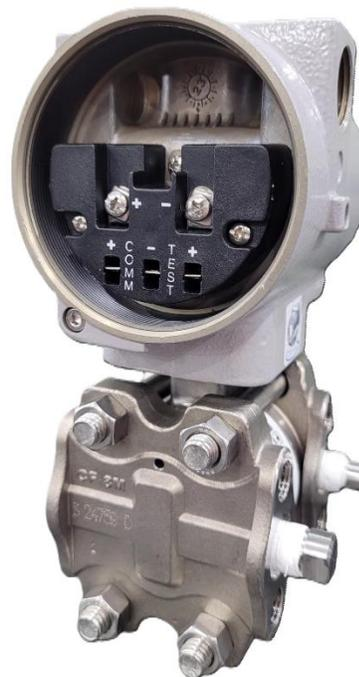
**Figura 7 – Borneira equipamento HART**
