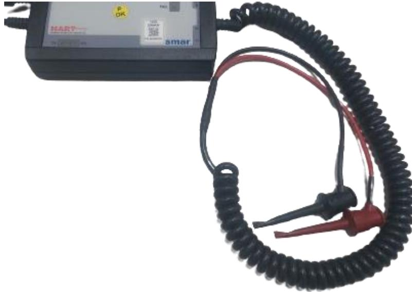
**Figura 6 – Garras retráteis para conexão com equipamento HART**
