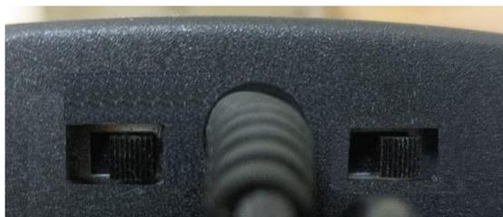
Figura 11 – Detalhe das chaves seletoras NET/LOCAL e I/V
