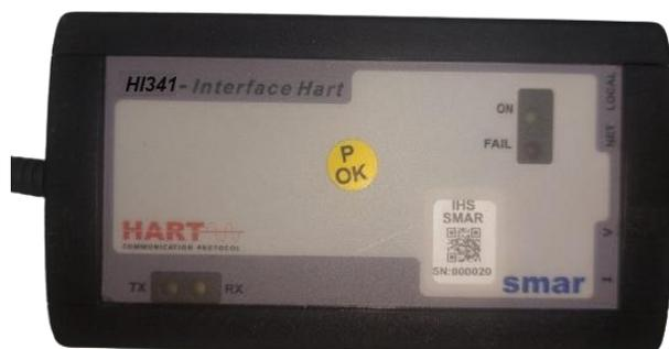
Figura 10 – Indicação das chaves seletoras NET/LOCAL e I/V
